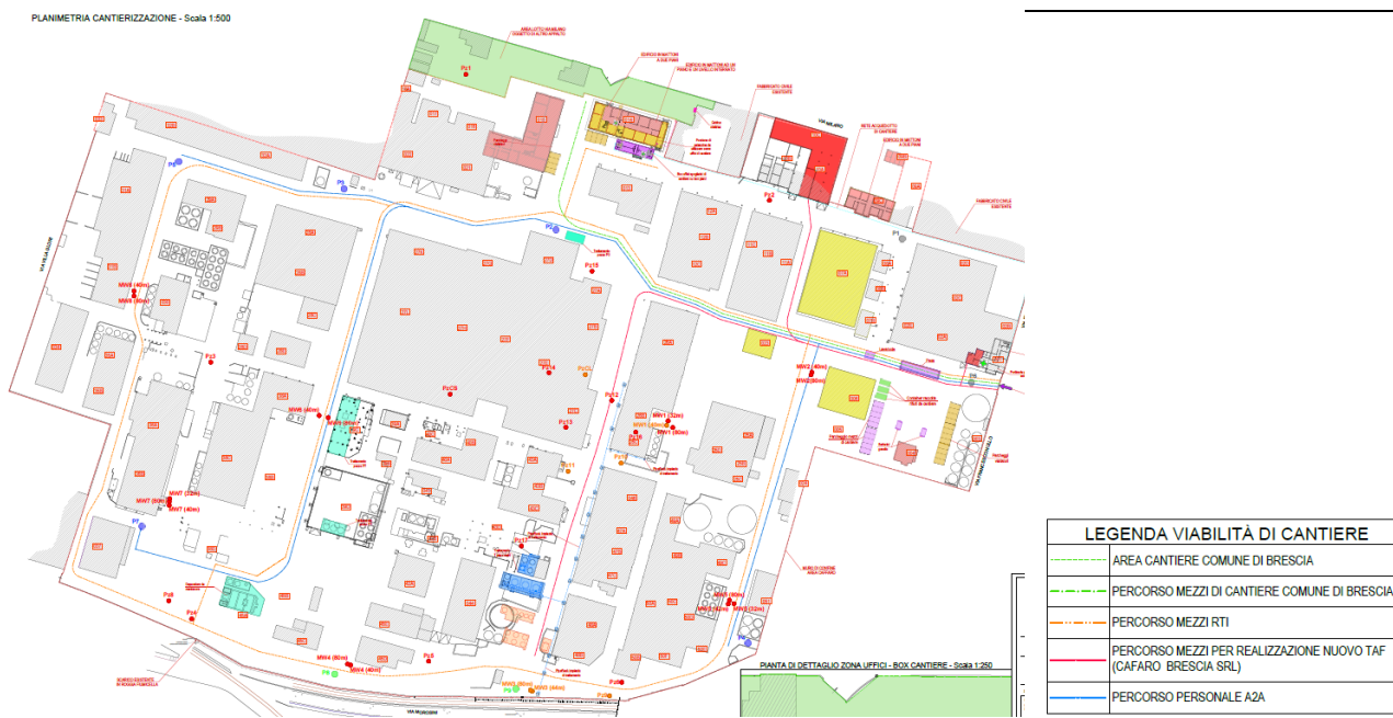
Figura 16: viabilità layout di cantiere
